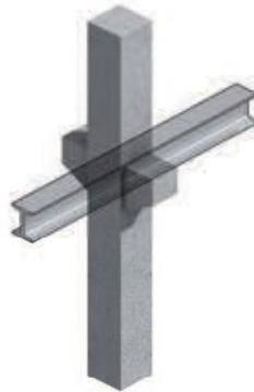
Mensole per vie di corsa carroponte
